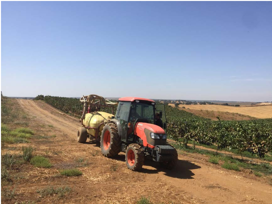
Trattore con il serbatoio di Anolyte e il Sistema di nebulizzazione
